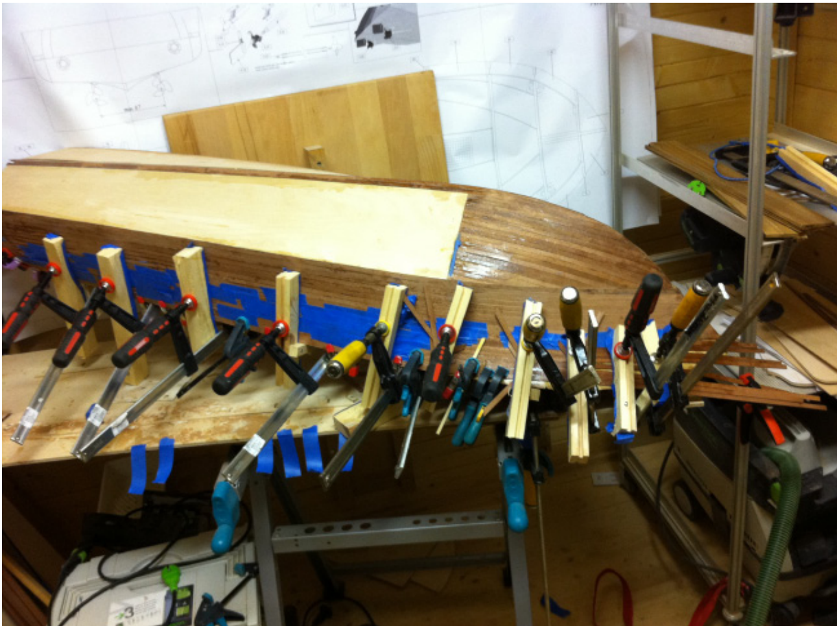
Beklædning med mahogni lister, der benyttes afdækningstape for at hindre at "presseklodser" limes fast til mahogni lister. Til limning er der benyttet Epoxy af mærket WEST SYSTEM.
