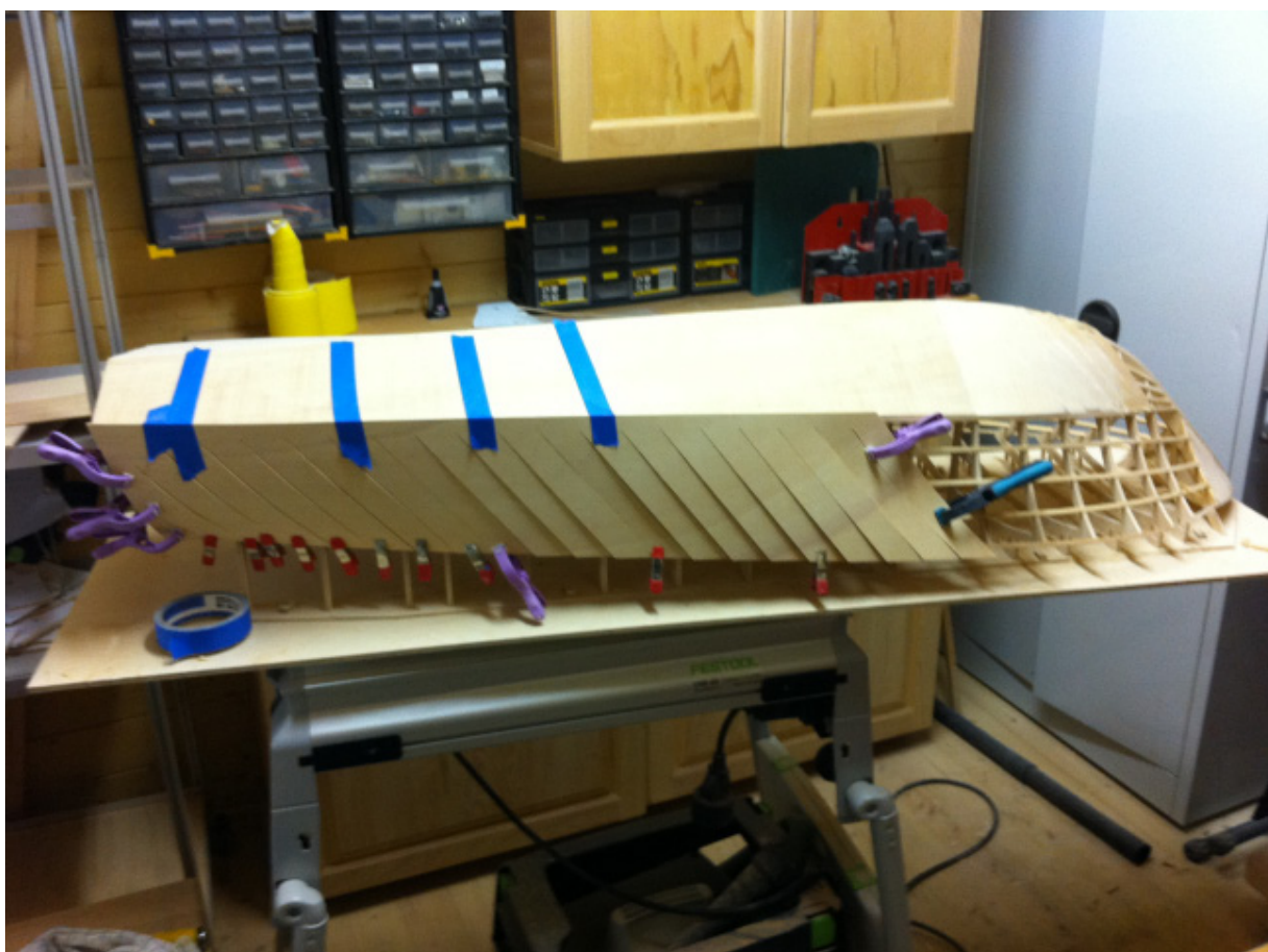
Tilpasning af sidebeklædning, der er slidset op for nemmere at få det til at følge skrogets linjer
