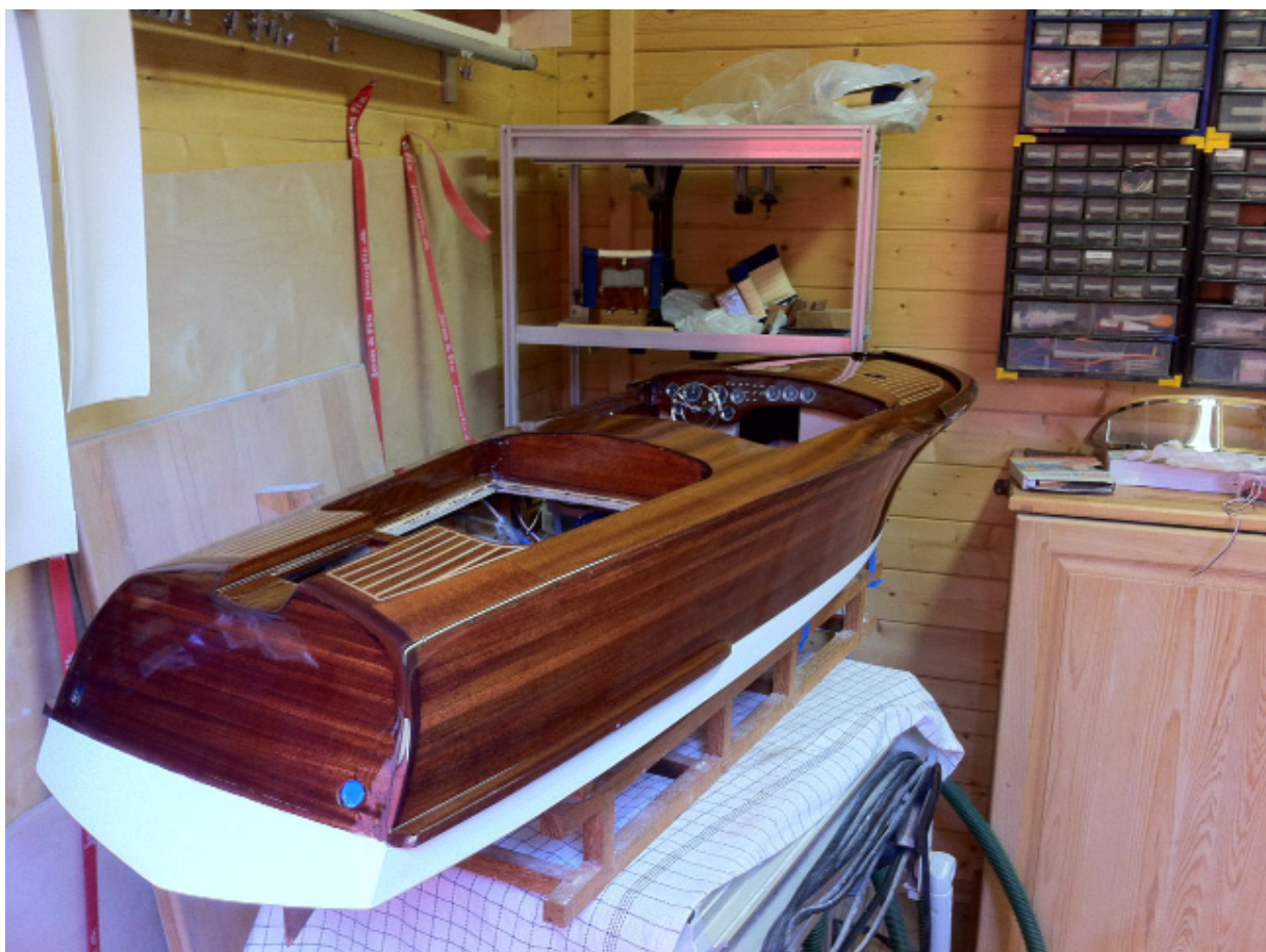
Lakarbejde er nu færdig, 26 lag lak giver en ualmindelig flot overflade, instrumenter og rat monteret
