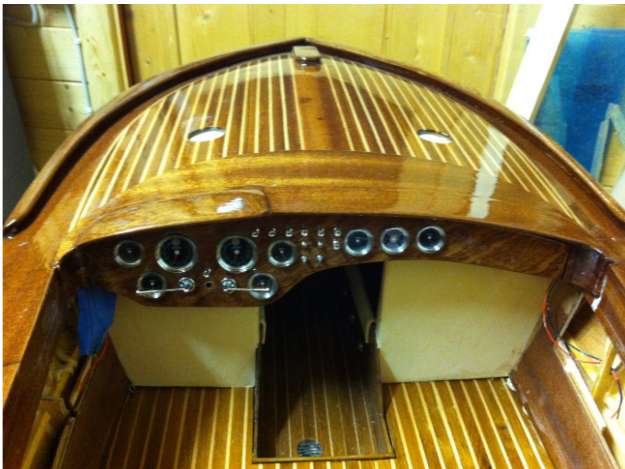
Prøvemontage af instrumenter, åbninger i sider er til servoer der skal styre rattet og gashåndtags bevægelser, dørk er beklædt med egetræ og birke lister
