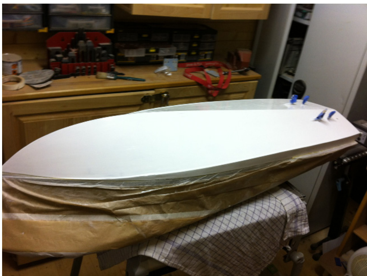
Bund er nu færdigmalet med Epifanes Polyurethane maling
