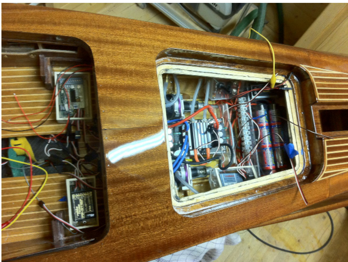
Inden montering af fittings og beklædning af kanter mm. med kunstlæder, monteres og testes elektronikken.
