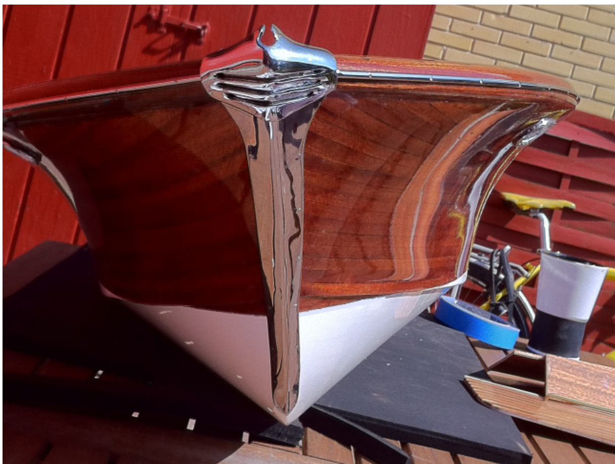
Montering af de mange speciel fremstille dele i messing der efterfølgende er blevet forkromet, starter med stævnplade, snude og sidelister,
