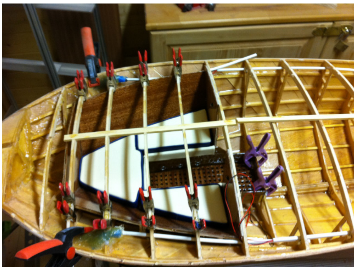
Hyndeplader og sider i kahyt monteres efter behandling med epoxy PERMAKOTE, de løse hynder og rist i bund, fjernes inden videre arbejde.
