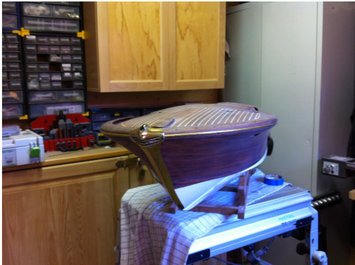
Lakeret flader er slebet, for 5 gang og stævnplade, snude og sidelister monteres og tilpasses inden forkromning.
